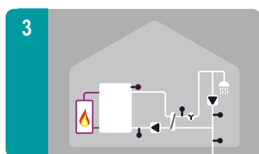
ГВС с рециркуляцией и дополнительная функция термостата
